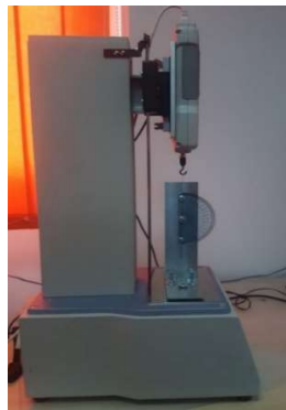
Figura 7.1 Stand de testare cu arcul ortodontic atașat de cele trei bracketuri și pregătit pentru aplicarea forțelor de tracțiune
