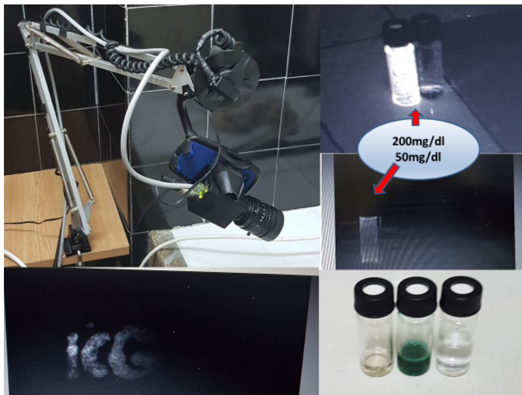
Fig.4 Prototipul Indo-Viewer și aspect NIR al soluțiilor de ICG
