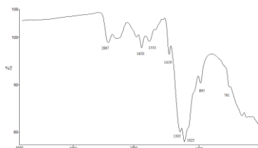
Fig.V.20. Spectrul FTIR pentru proba de chitosan CT 1
